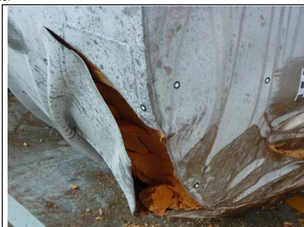
Figure 11 : Déchirure d'une soudure d'un emballage après une épreuve de chute
