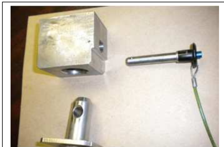
Photo des broches (à droite sur la photo) : les broches présentes sur une demi-coque se verrouillent dans un orifice situé dans l'autre demi-coques au moment de la fermeture de la coque de protection
